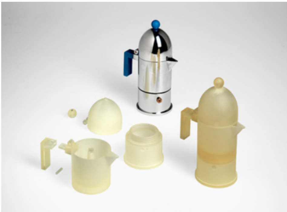
3. kép. Nagyon hasznos eszköz a 3D nyomtatás, amely csak egy lehetőség a gyors prototípusgyártásra.
